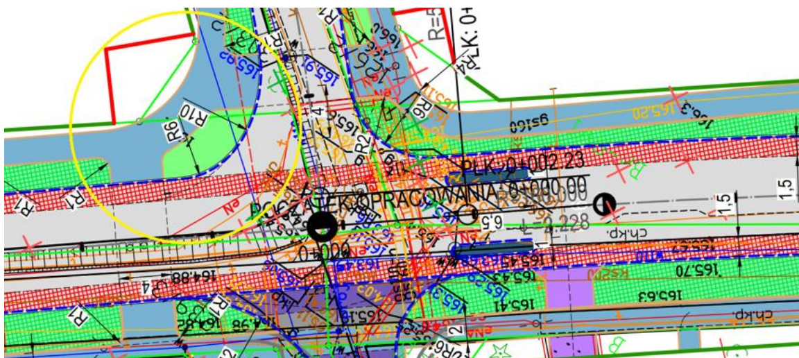
Rysunek 29 Przykład poszerzenia chodnika pomiędzy przejściami dla pieszych w obrębie skrzyżowania – zasoby własne Wydziału Inwestycji – UM Gdynia
