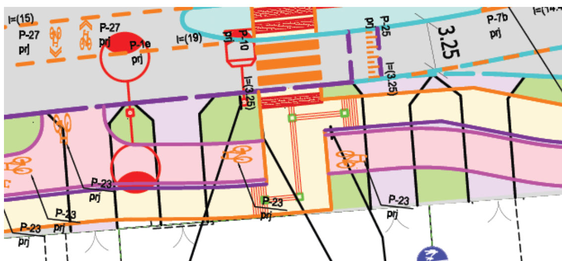
Rysunek 18 Przykład chodnika przejezdnego w miejscu przecięcia z DDR – zasoby własne Wydziału Inwestycji – UM Gdynia
